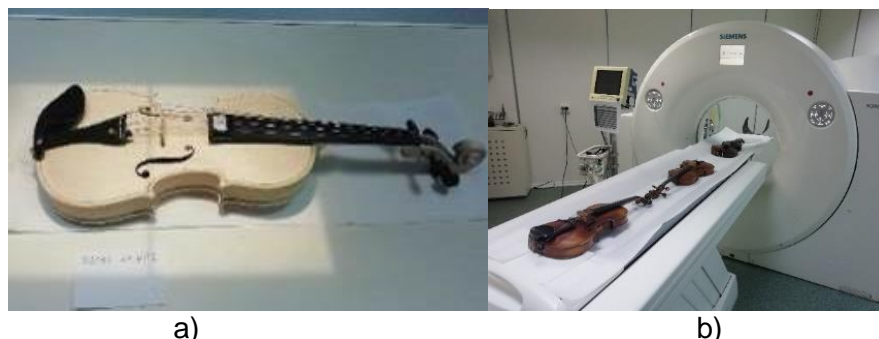
Figura 3. Viori vechi analizate prin metode neinvazive și nedistructive: a) radiografierea vioarei cu raze X; b) analiza la computer tomograf a violorilor vechi
