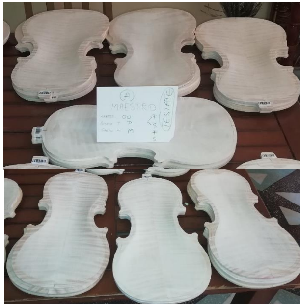
Fig. 5 Modelele de plăci din structura viitoarelor modele demonstrative de violi (clasa A – maestro)
